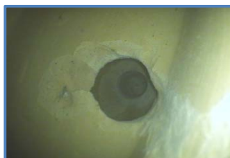
E1-2: Scatto eseguito a circa 20 cm da inizio foro: fine laterizio forato ed inizio soletta in calcestruzzo.
