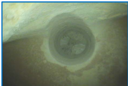
E3-2: Scatto eseguito a circa 12 cm da inizio foro: fine laterizio forato ed inizio soletta in calcestruzzo.
