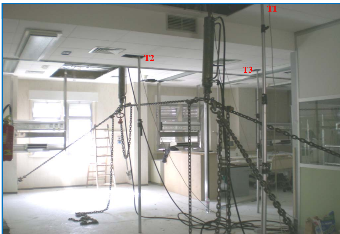
Martinetti oleodinamici per l'applicazione del carico e trasduttori elettronici montati su aste telescopiche in posizione di collaborazione laterale
